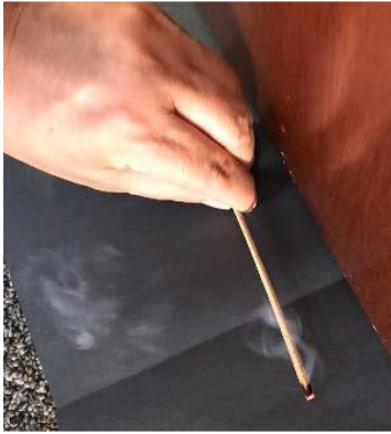
Hình 10. Sử dụng ống tạo khói hoặc que hương để kiểm tra hướng dòng khí (1).
