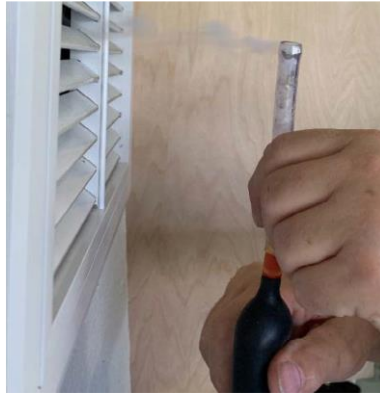
Hình 10. Sử dụng ống tạo khói hoặc que hương để kiểm tra hướng dòng khí (1).
