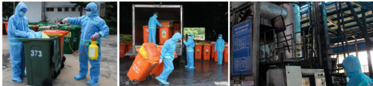
Chất thải y tế được xử lý khép kín, triệt để bằng công nghệ đốt nhiệt độ cao - có thể lên đến 1400 độ C, công suất 21 tấn/ngày. Hệ thống kiểm soát nhiệt độ và khí thải tự động, khí thải xử lý đạt Quy chuẩn Việt Nam hiện hành. Tro thải sau khi đốt phải hóa rắn, chôn lấp an toàn tại hầm dành riêng CTNH. (Ảnh: Công ty Môi Trường Đô Thị Tp.HCM (Citenco) - Đối tác xử lý CTNH của Môi Trường Á Châu từ năm 2012)
